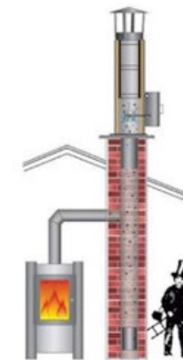
图7： 木材及其他固体燃料火炉的过滤器可以安装在烟囱内或者集成到火炉中
