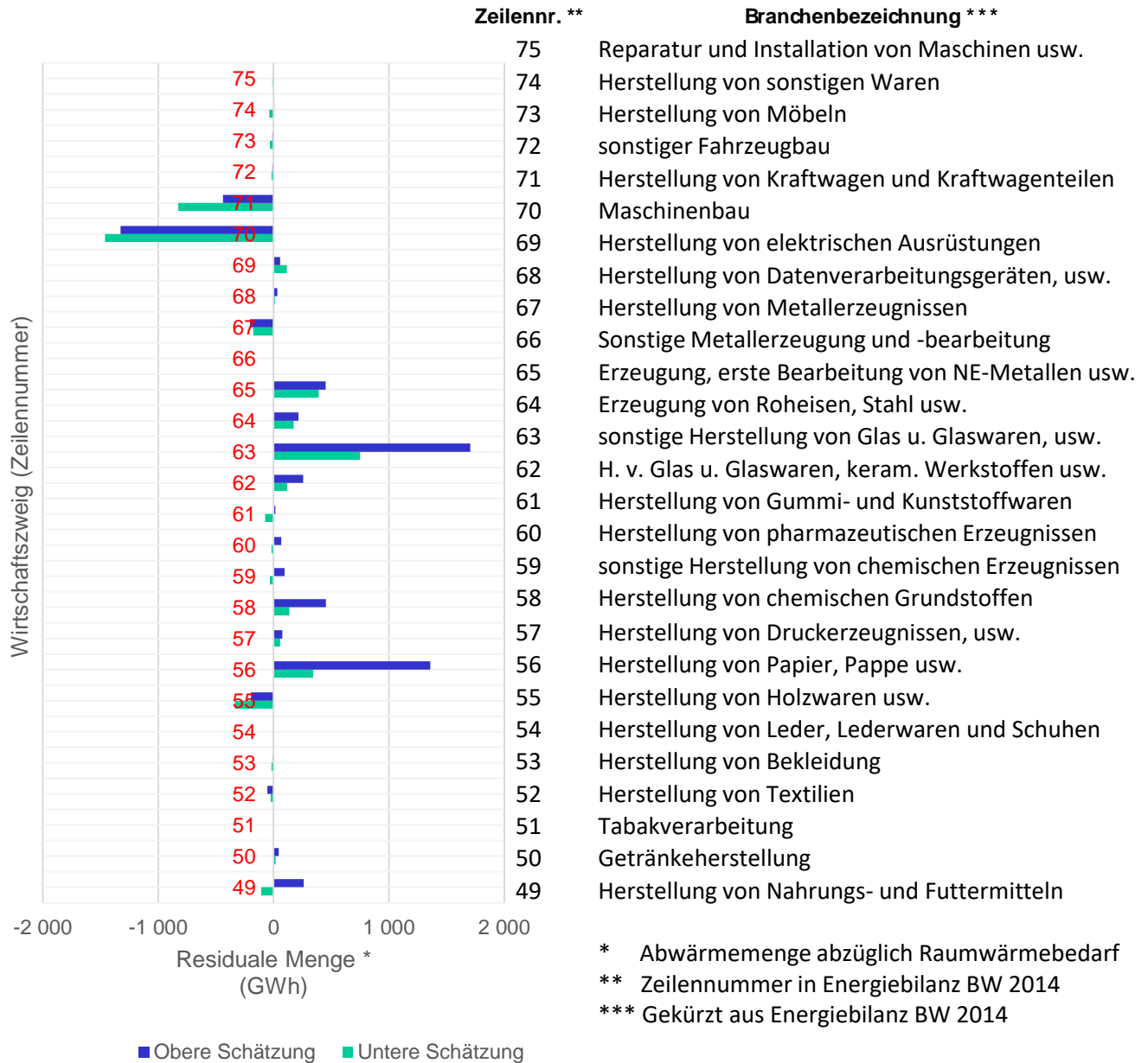
Abbildung 1-12: Bilanzierung des Potenzials für Wärmeintegration
